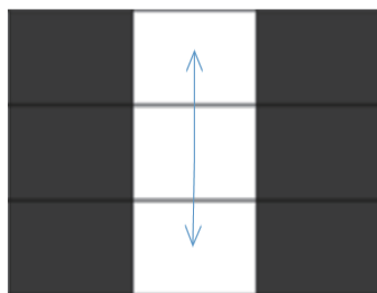
图4 栅格法中机器人的可移动方向
