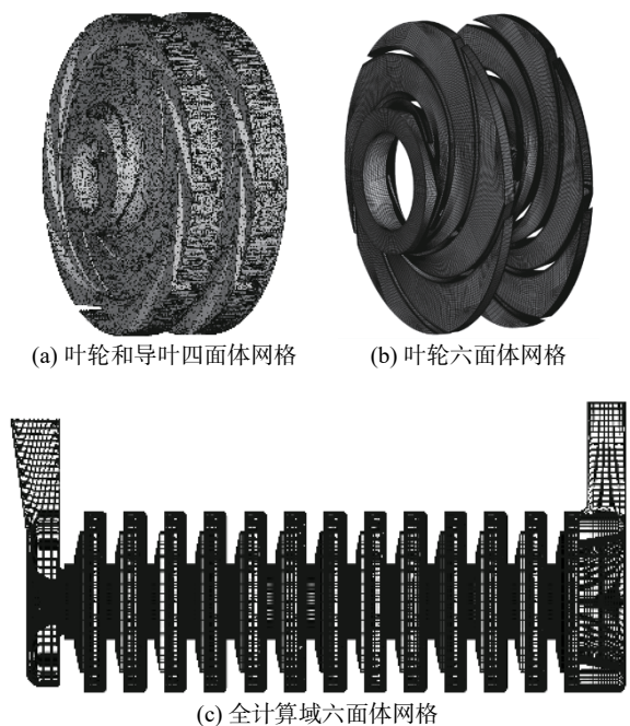
图 1 多级泵网格划分
