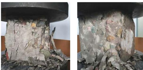
图 3 不同浆体类型混凝土的受压破坏形态
