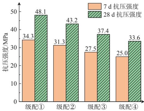
图 4 级配组成对混凝土强度的影响
